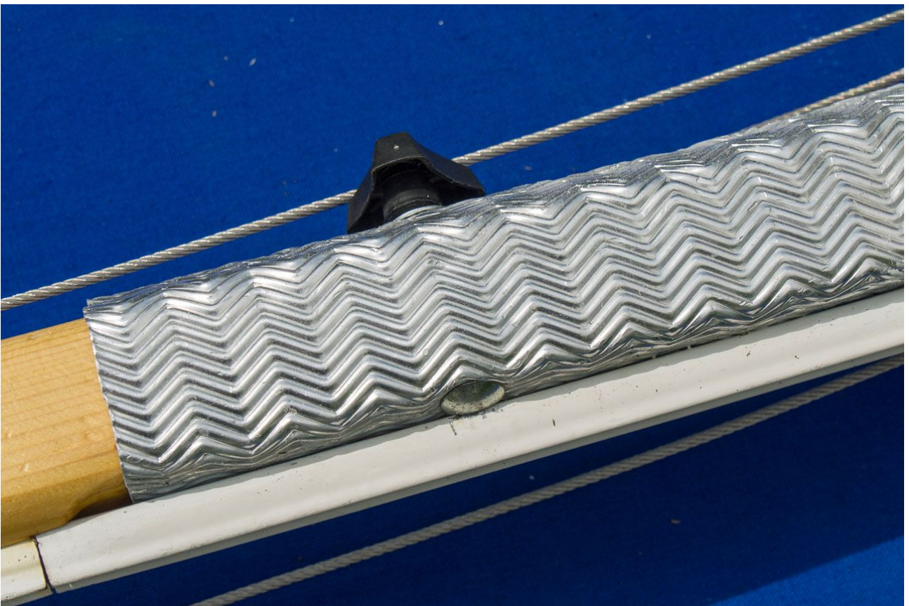
und verschrauben. Darauf achten, dass die Schiene gut durchgängig ist für die Mastrutscher.
