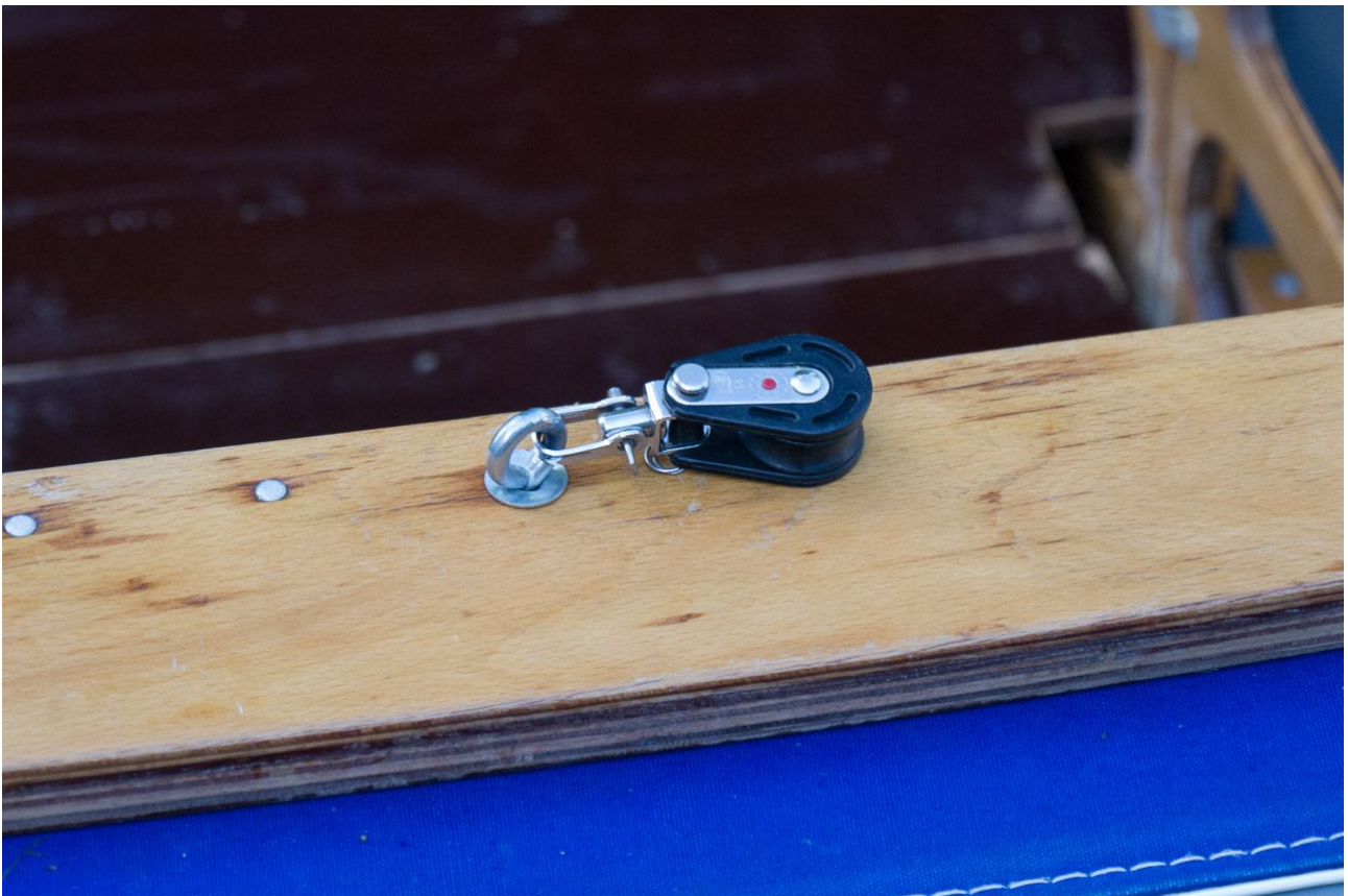
Umlenkrollen für Fockschoten einsetzen (meist mittleres Loch)
