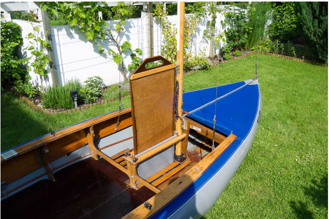
Steckschwert erst im Wasser bei genügend Tiefgang einschieben und beim Anlanden rechtzeitig aufholen, sonst Harakiri! :-)
