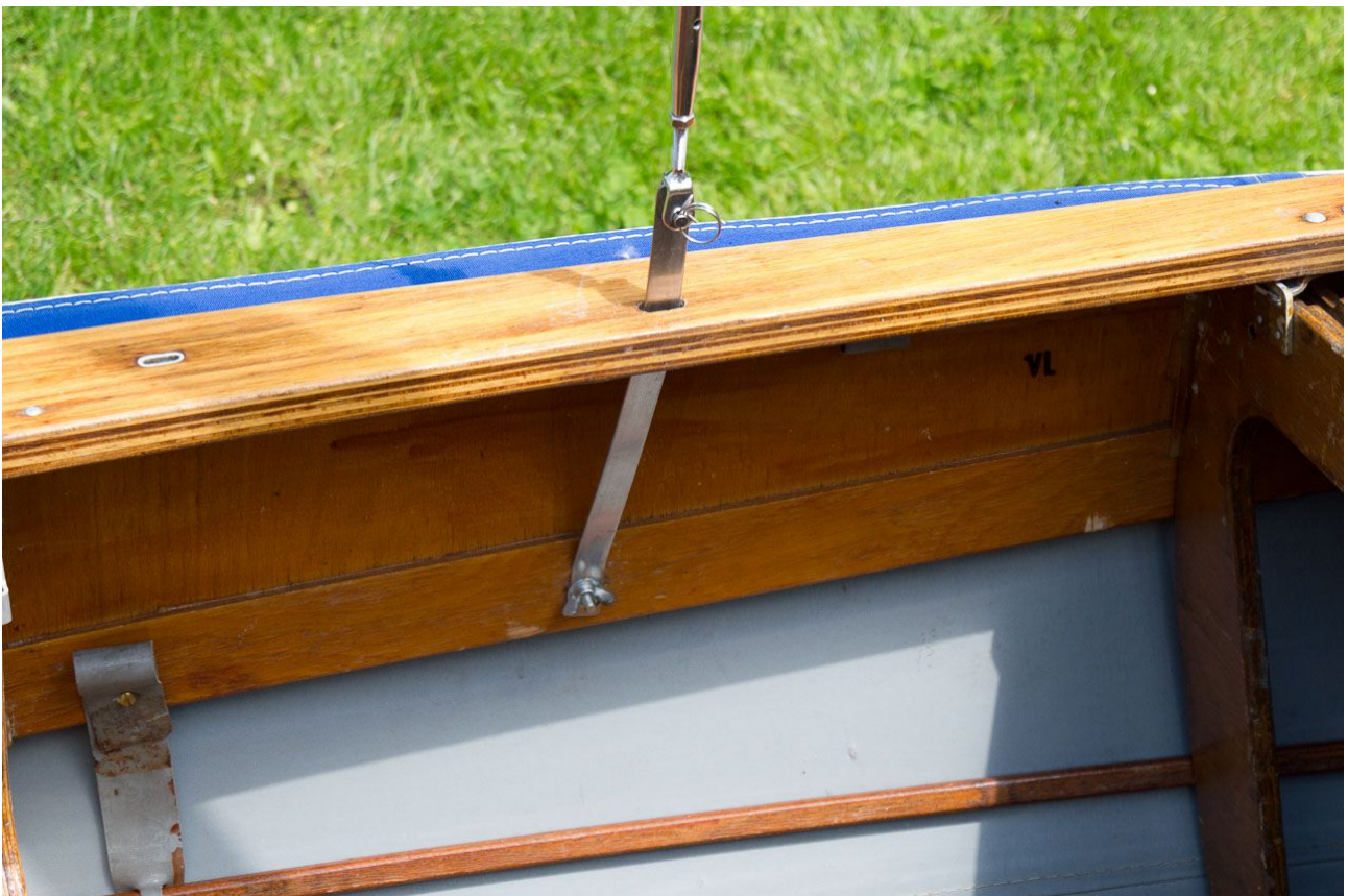
Wantenhalter durch Langlöcher in Reling führen und an der Bordwand verschrauben
