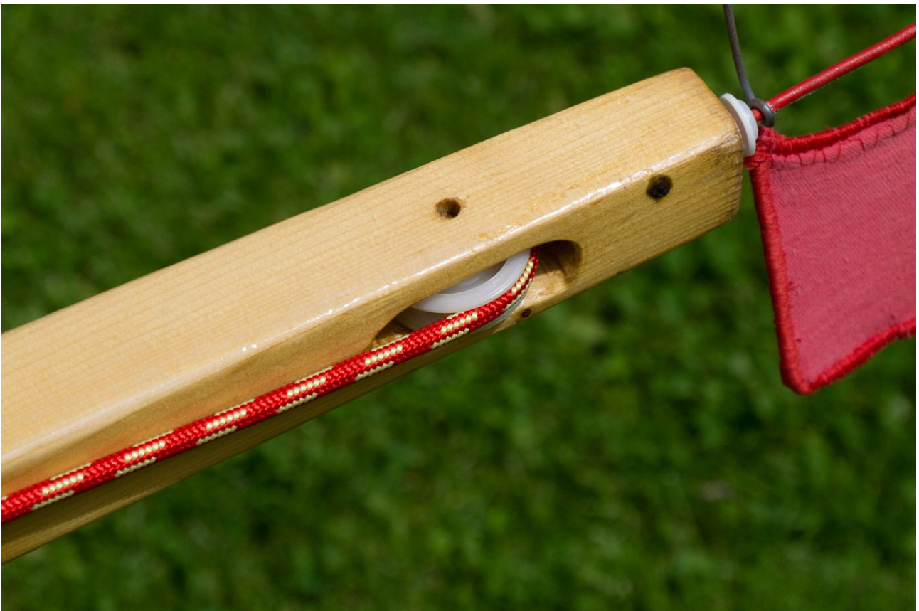
Großfall durch Mastrolle fädeln (Schäkel für Segel auf die Seite der Schiene). Groß- und Fockfall (beide Enden!) unten am Mast befestigen.
