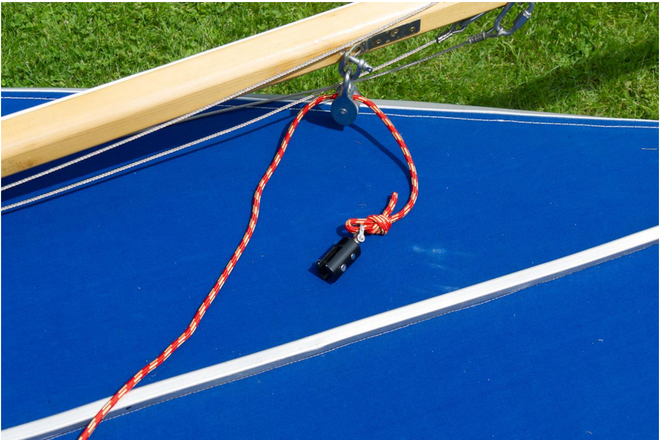
Fockfall in Rolle einfädeln (Topwirbel nach außen = vorn)
