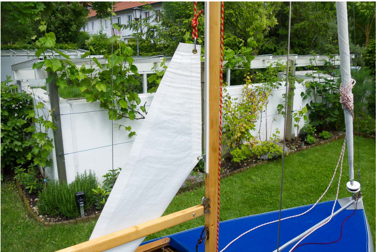
Großsegel setzen und auf Klampe belegen. (Mastrutscher in Schiene, beim Aufziehen bei Bedarf unten am Vorliek gehalten, damit sich die Mastrutscher nicht verkanten. Analog bei Bergen des Segels mit der Großschot „von oben“ gehalten.)
