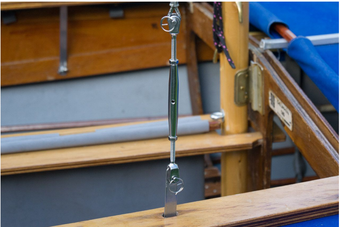
Wantenspannung über Wantenspanner einstellen (wirklich nur bei Bedarf - normalerweise nie!)
