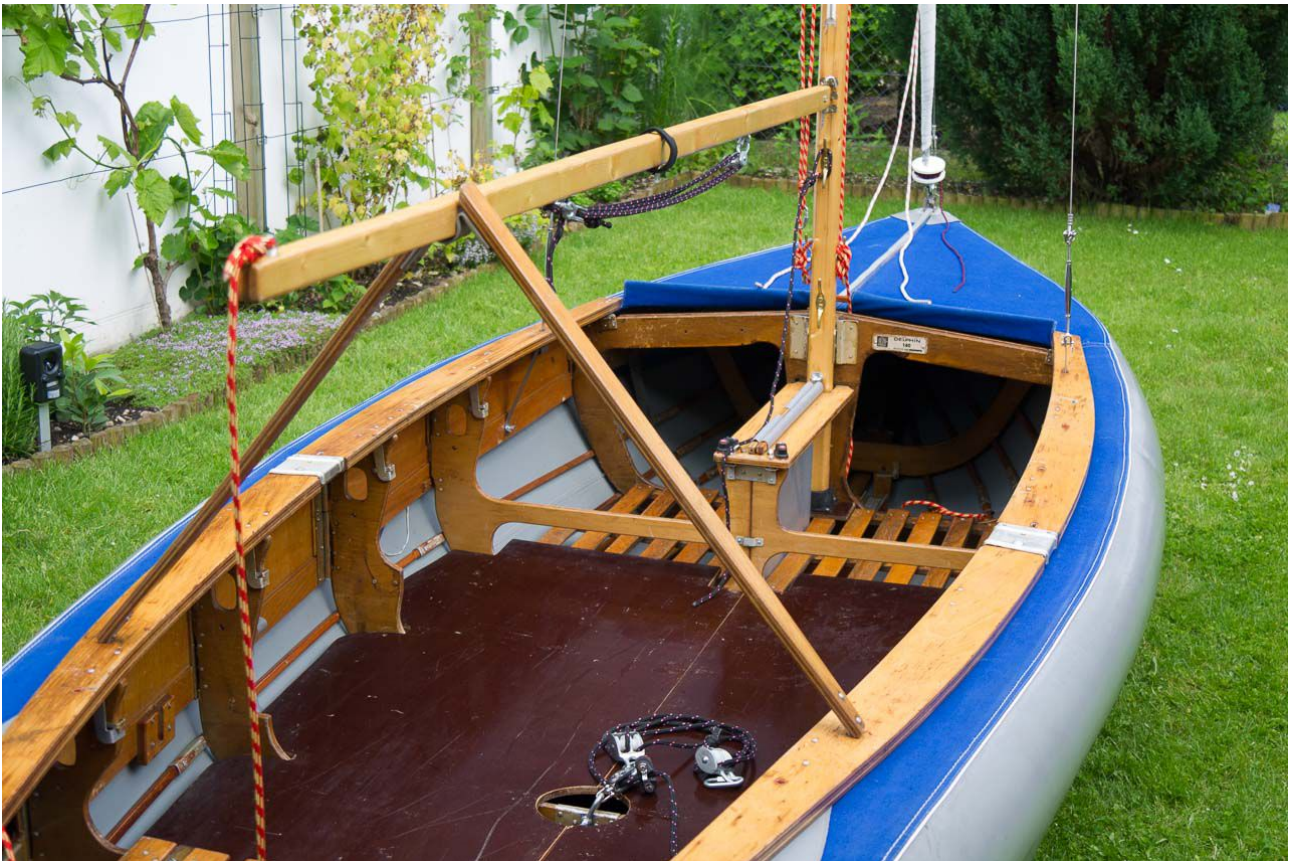
Großbaum kann bei Bedarf auf Stütze aufgelegt werden (original auch für Persenning, wenn man im Boot übernachten wollte)
