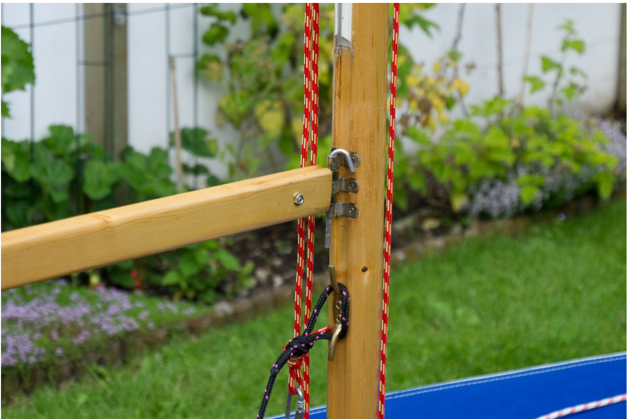
Großbaum am Mast einhängen (Lummelbeschlag)
