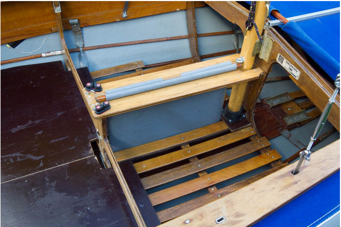
Mast aufrichten und in Mastfuß stellen (Hilfsperson!)
