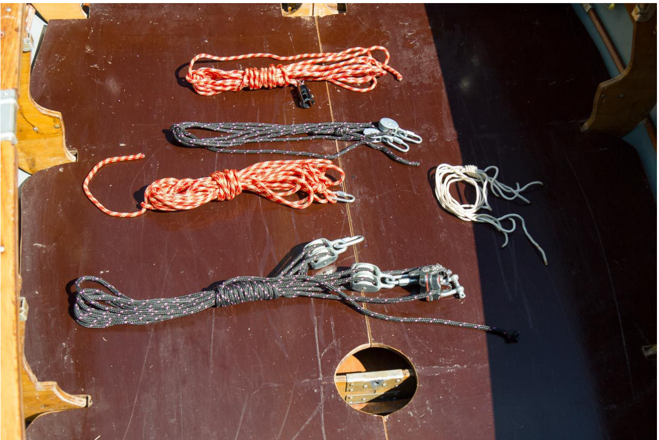
laufendes Gut von oben nach unten: Fockfall mit Topwirbel, Baumniederholer, Großfall, Großschot mit Blöcken (Flaschenzug), rechts: Zeisinge (Reffbändsel)
