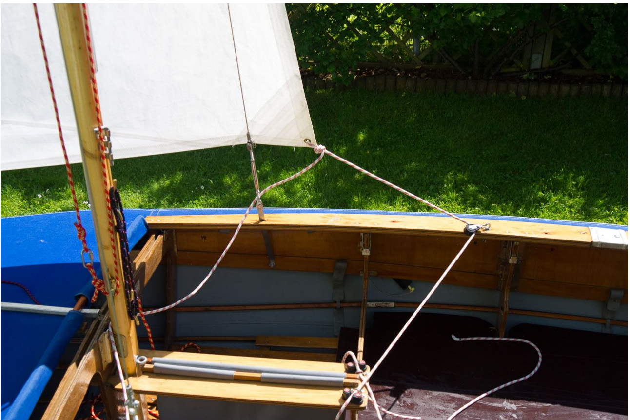
Lauf der Fockschoten im Einsatz (über Kreuz auf Curryklemmen zu belegen)
