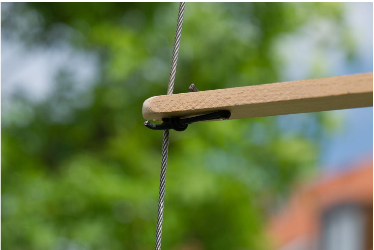
Gummischnur 2-3 mal um Wante wickeln und in Schraube einhängen
