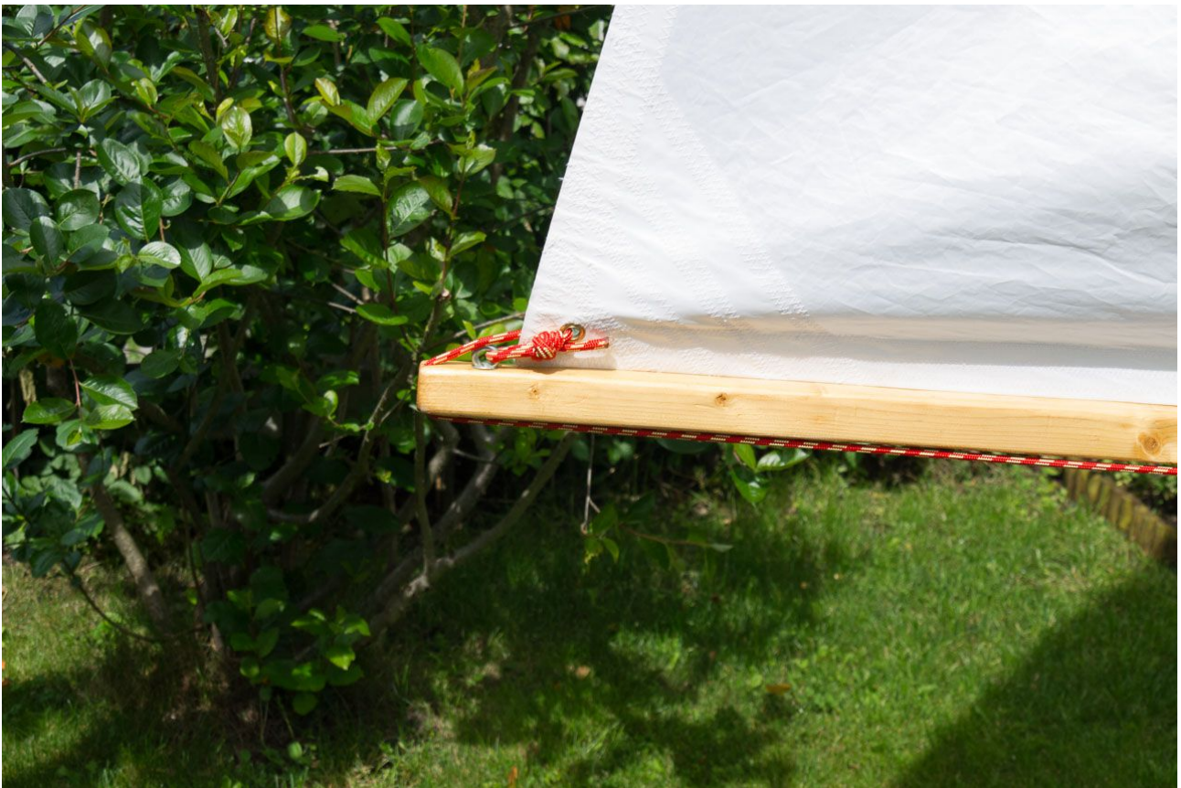
Unterliek strecken über Öse am Großsegel und Nut am Großbaum, auf Klampe am Großbaum belegen. (Dabei Großschot frei lassen, nicht auf Curryklemme belegen!)
