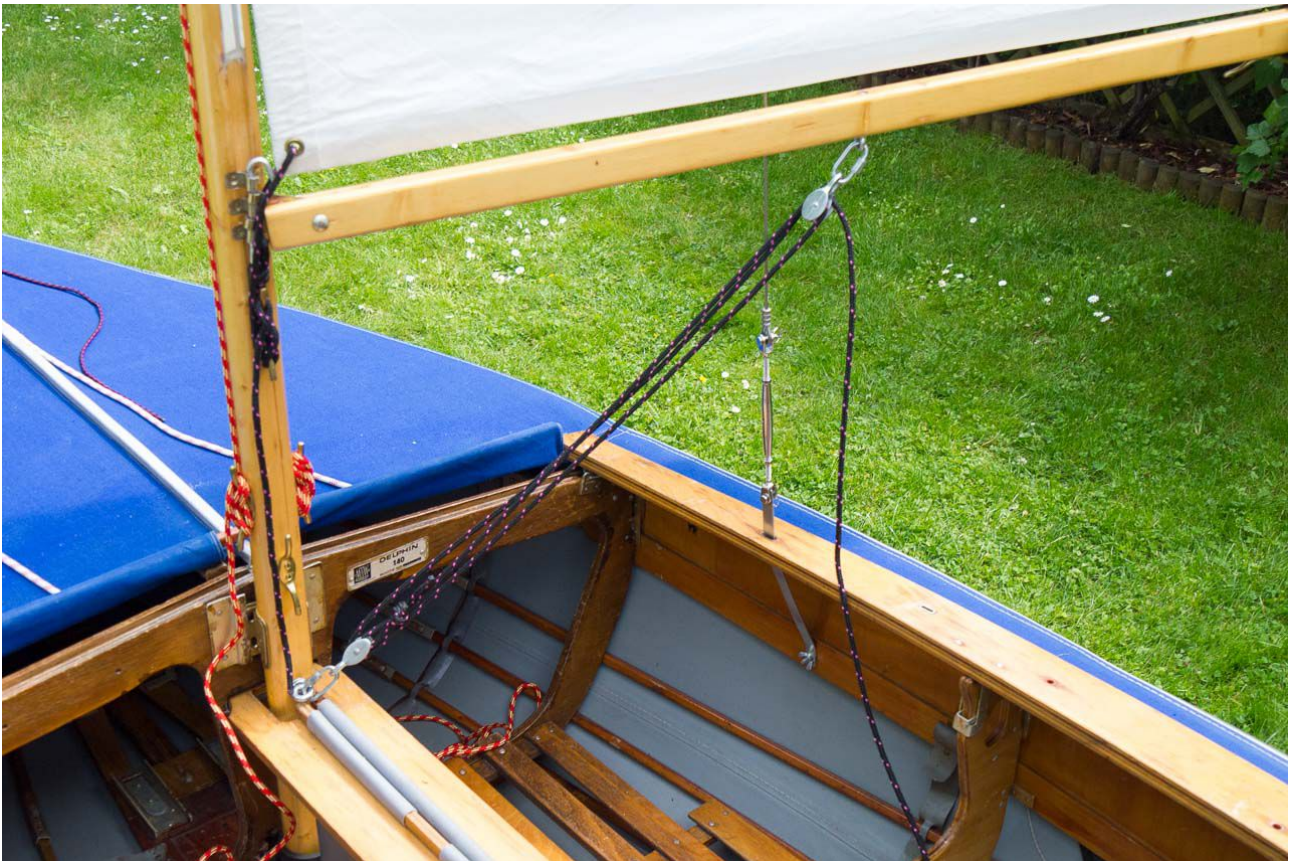
Baumniederholer an Ösen anschlagen (am besten noch ohne gesetztes Segel)
