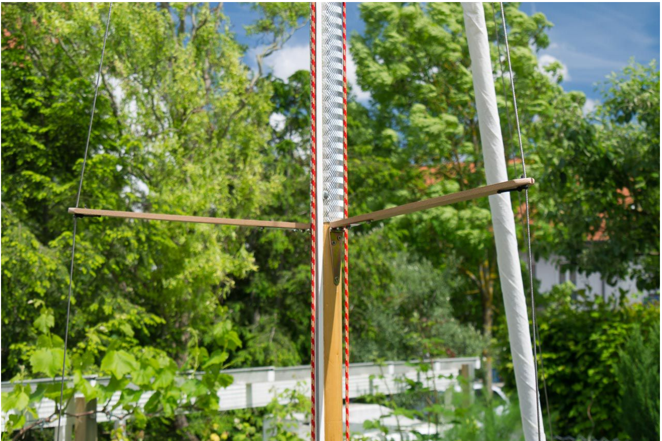
Saling in Wanten einhängen (leichter Winkel nach oben)
