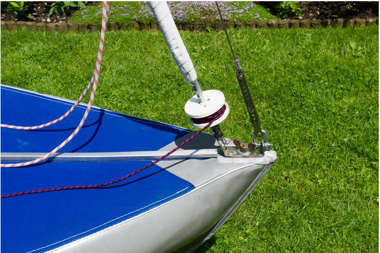
(noch aufgerollte!) Fock im Bugbeschlag befestigen, aufziehen und Fockfall an der Klampe am Mast belegen
