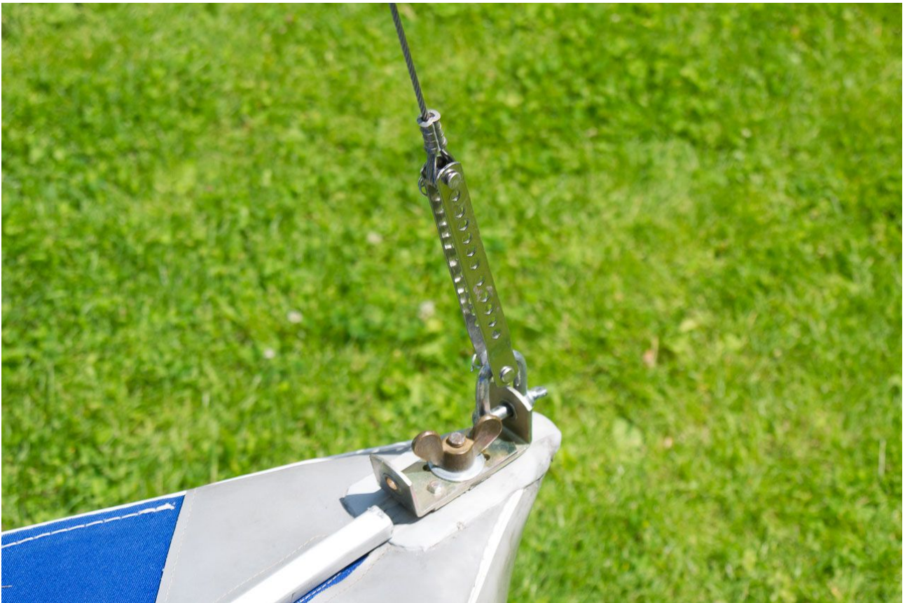
Vorstag im Bugbeschlag befestigen (Schäkel + Hilfsperson)
